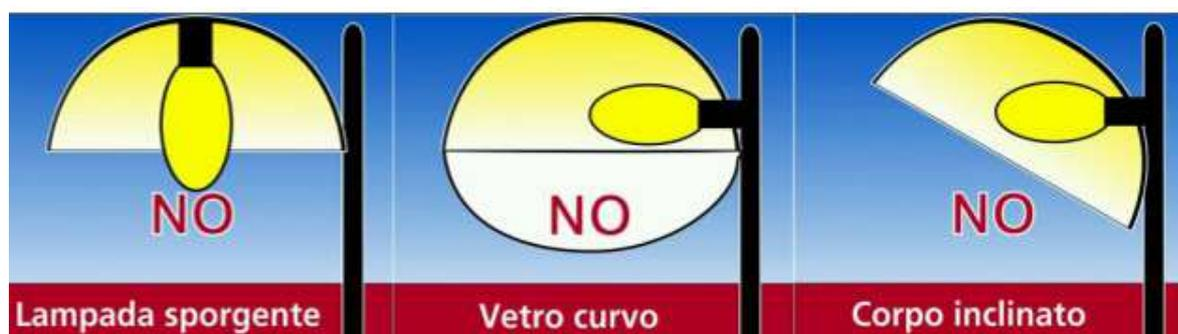
Figura 3 – Apparecchi non conformi alla L.R. (Estratto da Cielobuio)
