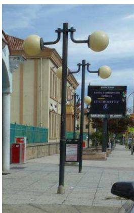
➤ **tipologia 24:** tale tipologia è costituita da un sostegno dritto e da chiusura con globo opaco; è presente lungo la strada di accesso al Basaura; l'impianto si trova in stato fatiscente e pertanto necessità di interventi di manutenzione straordinaria;
