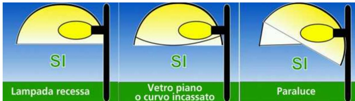
Figura 2 – Apparecchi conformi alla L.R. (Estratto da Cielobuio)
